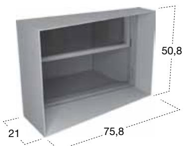
Termocamino a legna da incasso a parete dx o sx, con struttura in acciaio, funzione radiante o convettiva, suolo in refrattario ad alto contenuto di allumina e anta con vetro ceramico ad apertura a scomparsa.
