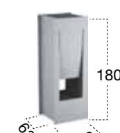
Caminetto bifacciale con struttura in acciaio predisposto ed utilizzabile con un solo bruciatore.
