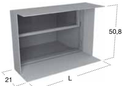
Termocamino a legna da incasso a parete, con struttura in acciaio, funzione radiante o convettiva, suolo in refrattario ad alto contenuto di allumina e anta con vetro ceramico ad apertura a scomparsa.
